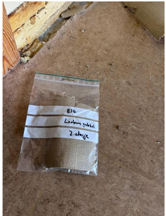
Bilde 22: Prøve B14a linoleum gulvbelegg (øverste lag)
