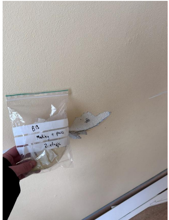
Bilde 34: Prøve B13 – farlig avfall på grunn av PCB7
