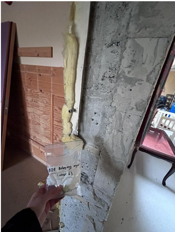
Bilde 39: Prøve B2E. Prøven sannsynligvis representerer nyere betong fra en rehabilitering omkring 2003
