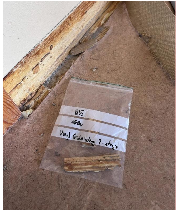
Bilde 28: Vinyl gulvbelegg 2. etasje (nederst lag) - påvist asbest
